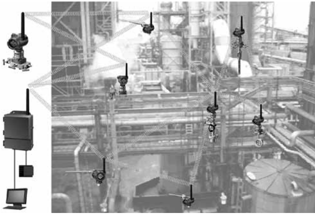
Рис. 2. Схема функционирования самоорганизующихся ячеистых сетей
