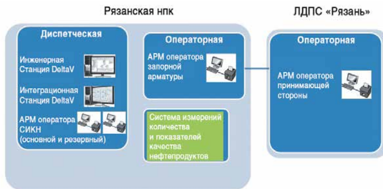
Рис. 3 Передача данных и связь системы измерений (СИКН) с сетью
