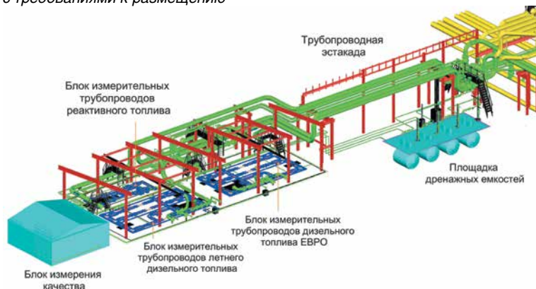
Рис. 2 Схема реализованного решения в соответствии с требованиями к размещению
