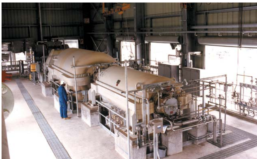
Рис. 1 Компрессор крекинг-газа – это самое важное оборудование на предприятиях по производству этилена. (Фото предоставлено компанией Elliott Co)
