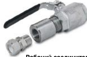
Рабочий соединитель (PN 23166-00) должен использоваться для подсоединения сенсора к набору шарового клапана 23240-00. Рабочий соединитель можно купить отдельно.
