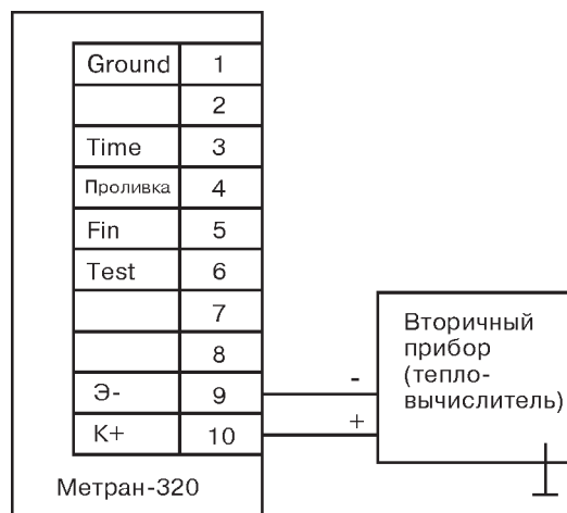
Рис. 1. Схема подключения расходомера Метран-320 к вторичному прибору.
