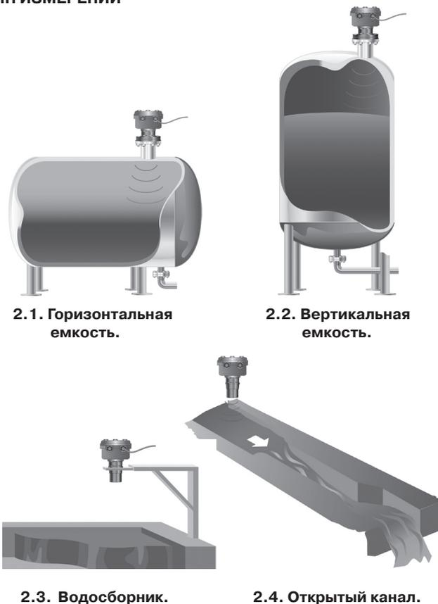
Рис. 2. Примеры установки уровнемеров 3100.
