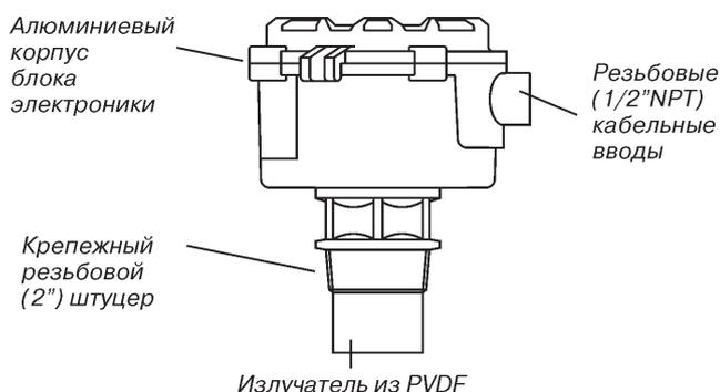
Рис.4. Конструкция уровнемера серии 3100 с алюминиевым корпусом.
