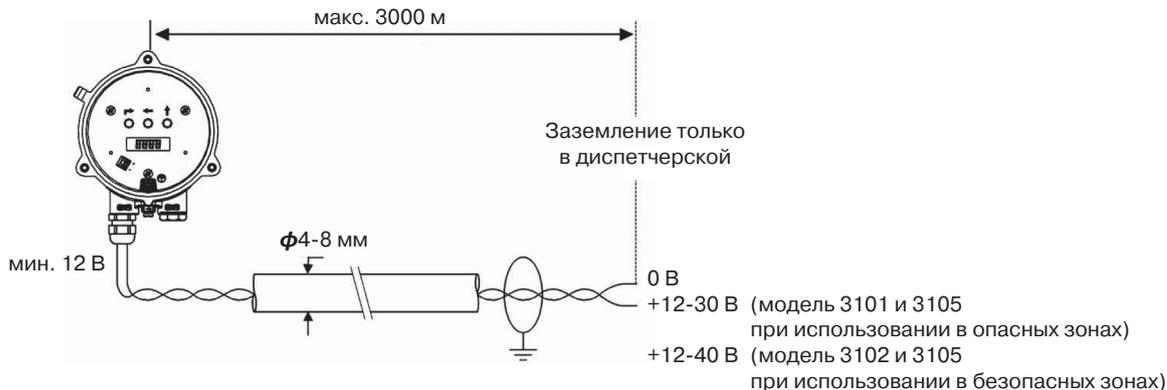
**Рис. 10. Схема подключения моделей 3101, 3102 и 3105 (искробезопасное исполнение).**
