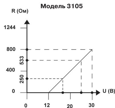
**Рис. 12. Диаграммы сопротивлений для уровнемера, сертифицированного на искробезопасность.**
