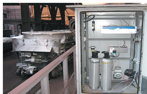
Система Rosemount Analytical одновременно контролирует выбросы CO, O 2 и CO 2 с каупера
