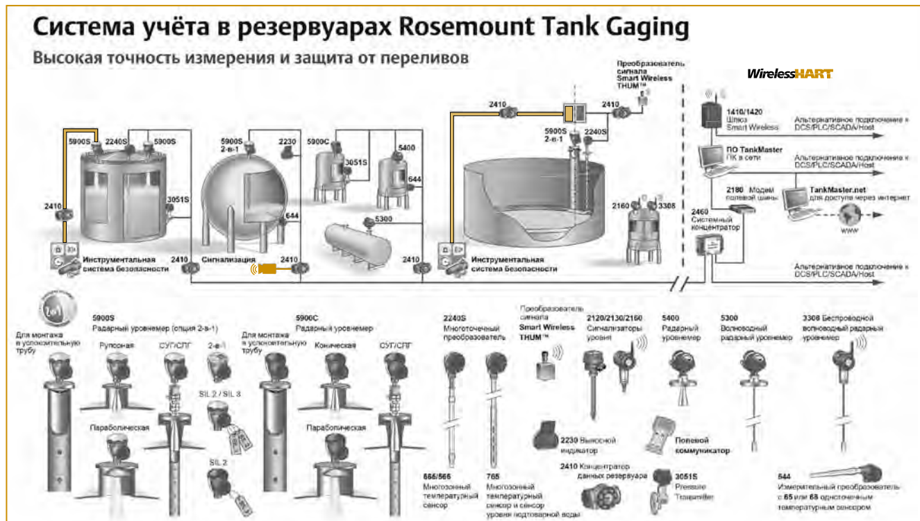
Рис. 1. Структурная схема системы ROSEMOUNT TANK GAUGING и оборудование, входящее в ее состав
