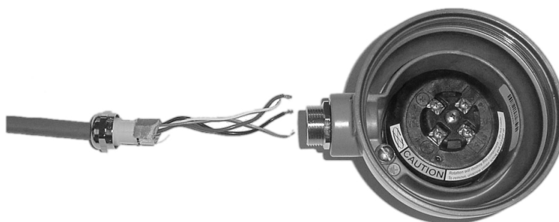
Slika 5 Osrednji del navojnega cevnega priključka in ohišje procesorja
