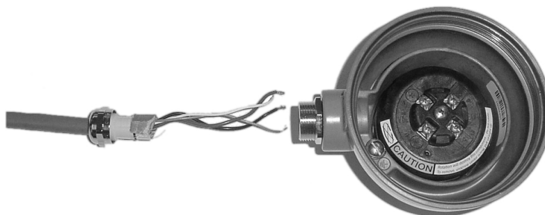
Kuva 10 Holkin runko ja anturielektroniikan kotelo
