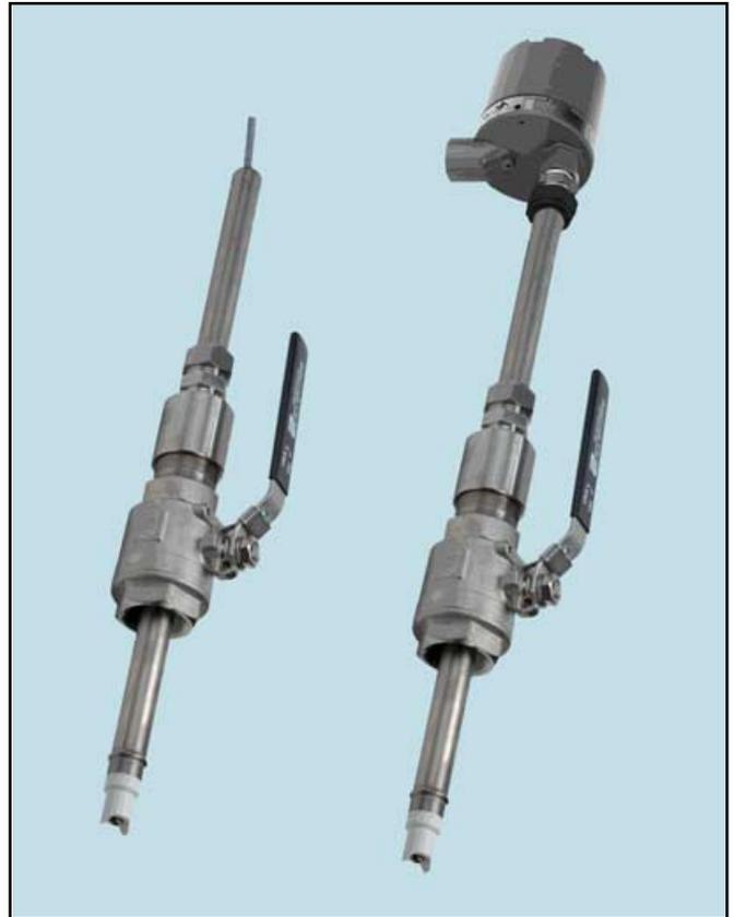
Einstabmesskette Modell 396R/ 398R TUpH mit Großflächendiaphragma aus modifiziertem Polypropylen oder Tefzel, Wechselarmatur mit Kugelhahn und Anschlussklemmenbox mit Vorverstärker
