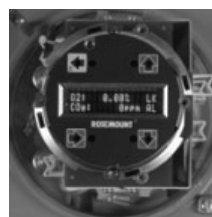
Корпус электронного блока с местным интерфейсом оператора
