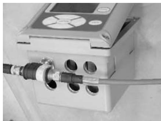
Profibus Adapter M12 angeschlossen an ein Profibus-Netzwerk über ein T-Kabelanschluss
