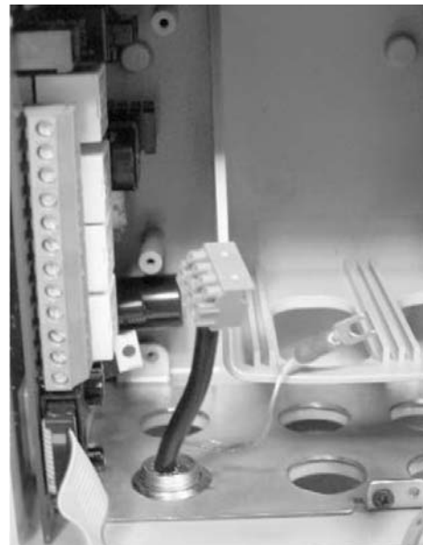
M12 Adapter angeschlossen an 4-poligen Profibus-Stecker
