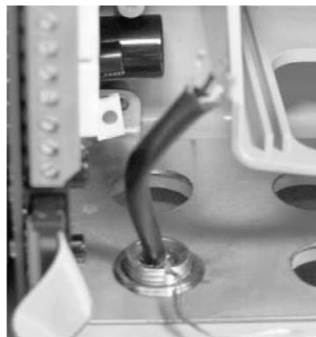
Befestigung der M12 Adapter/Kabelbaugruppe
