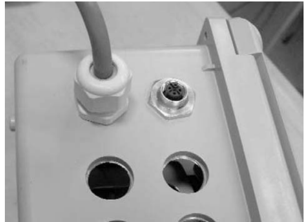
Richtige Kabeldurchführung für den M12 Adapter
