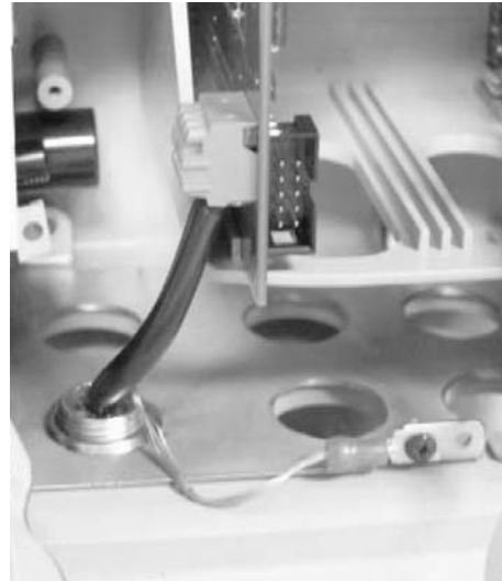
Profibus-Stecker montiert an der Profibus-Platine
