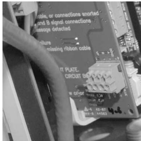
Profibus-Platine mit 4-poligem Anschlussstecker
