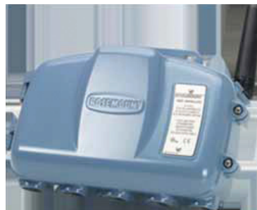
图 1. 罗斯蒙特无线高密度温度变送器 848T
