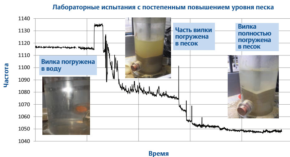
Рисунок 2-1. Изменение частоты колебаний вилки сигнализатора Rosemount 2160 при погружении вилки в жидкость и песок
