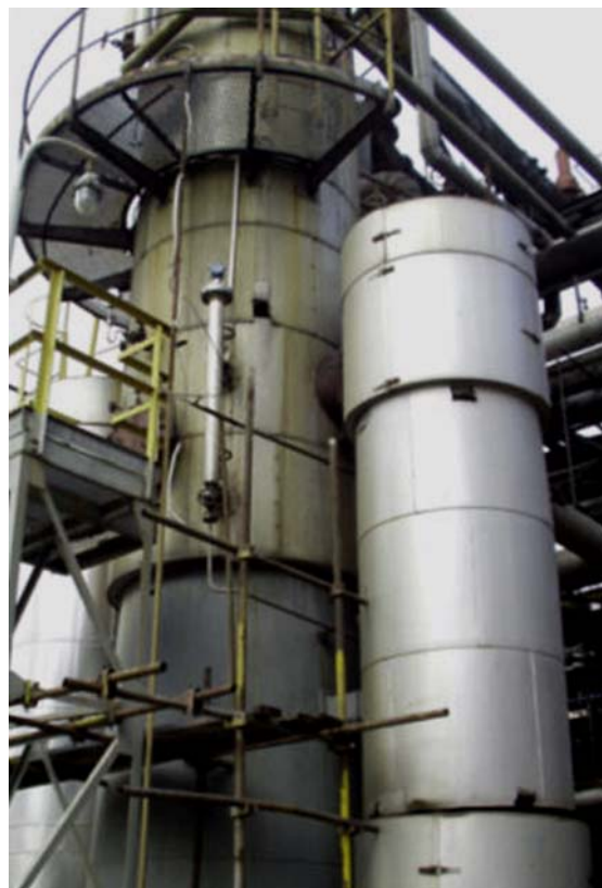
Rosemount 3300 によりメタノール蒸留塔でのレベル計測の信頼性が向上。
