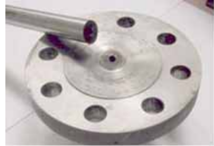
由于涡旋引起的振动所导致的热套管故障示例 (1)
