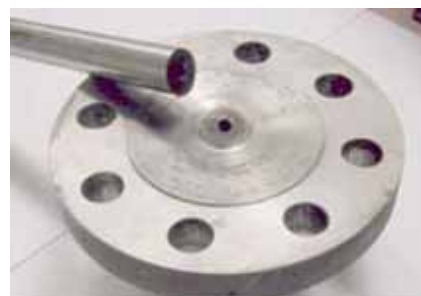
Пример усталости защитной гильзы вследствие вызванной вихрями вибрации. (2)
