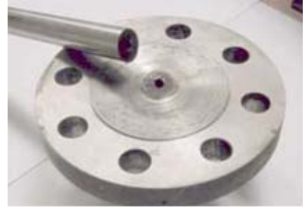
Ejemplo de un fallo de termopozo debido a vibraciones inducidas por vórtices (1)
