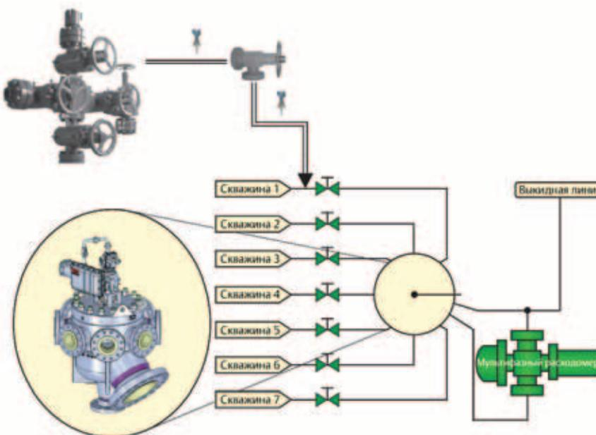
Рис. 2. Упрощенная система трубопроводов с многоходовым переключателем потока
