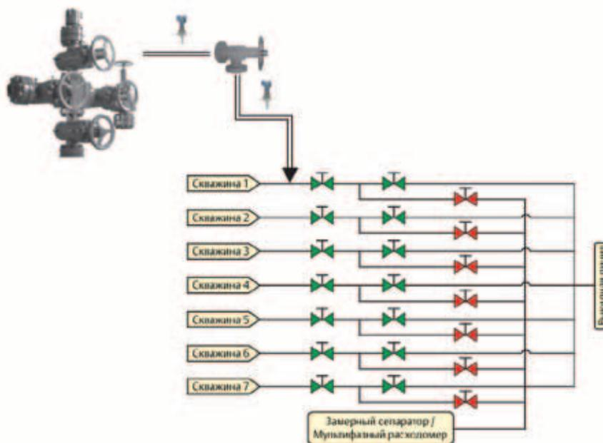
Рис. 1. Сеть трубопроводов с 7 скважинами и двойным манифольдом
