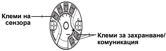
Фигура 1. Захранване, комуникация и сензорни клеми
