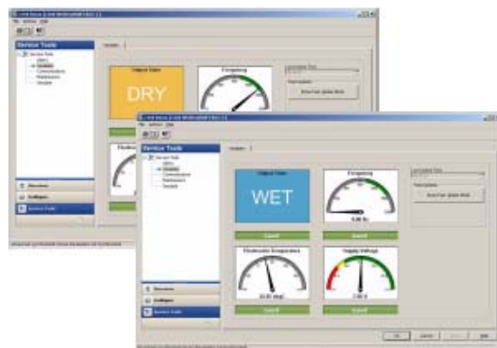
ПО AMS Suite обеспечивает мониторинг состояния сигнализатора
