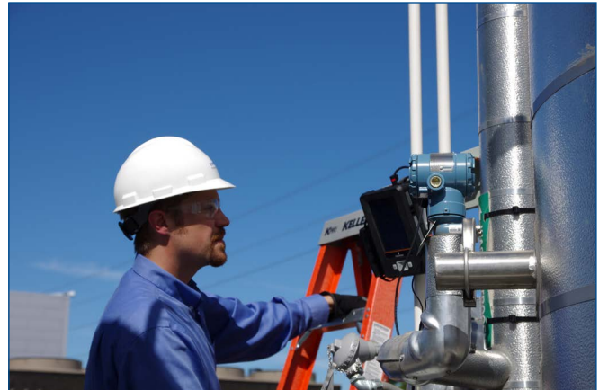
Il supporto magnetico è un accessorio che permette di appendere l'unità Trex ad una tubazione, liberando le mani per altri lavori.
