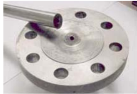
Exemple de défaillance de puits thermométrique due à des vibrations induites par des tourbillons (1)
