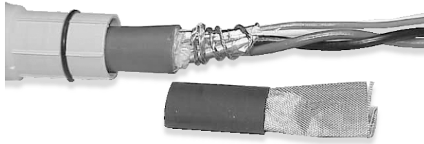
Figur 7 Så här lindar du skärmavledningskablarna
