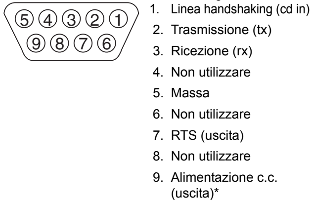
FIGURA 5. RS-232 DB-9 collegamenti
