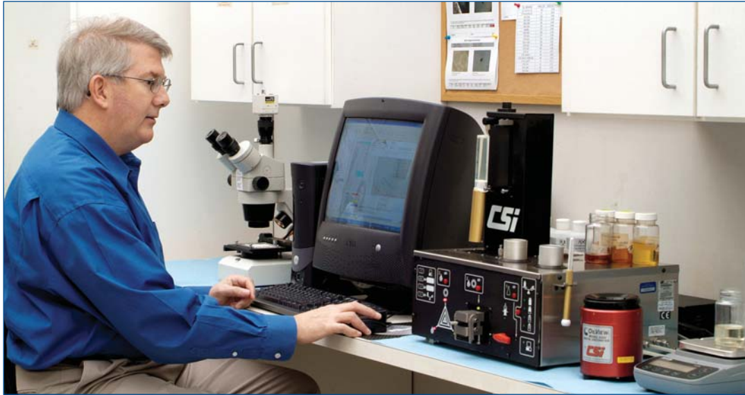
CSI 5200是迷你实验室的组成部分，该实验系统可提供全面的油液分析结果。
