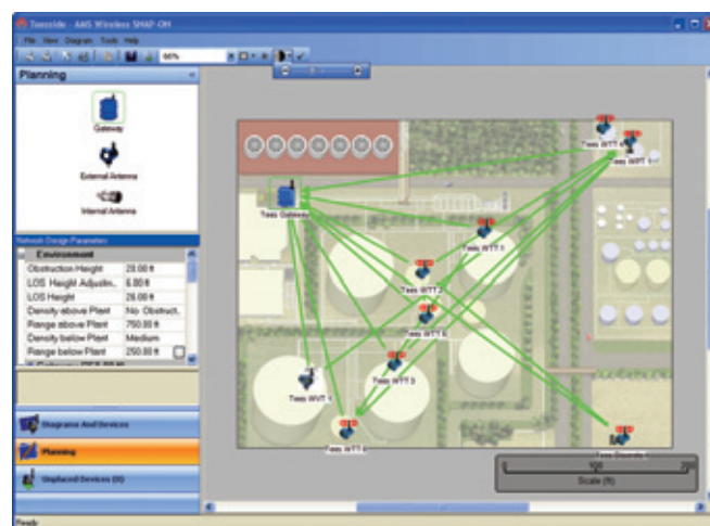
Za pomocą aplikacji AMS Wireless SNAP-ON można wyświetlić graficzny widok sieci bezprzewodowej.
