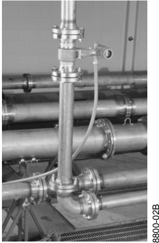
FIGURE 2. % de d calage du facteur K en pr sence d'un seul coude
