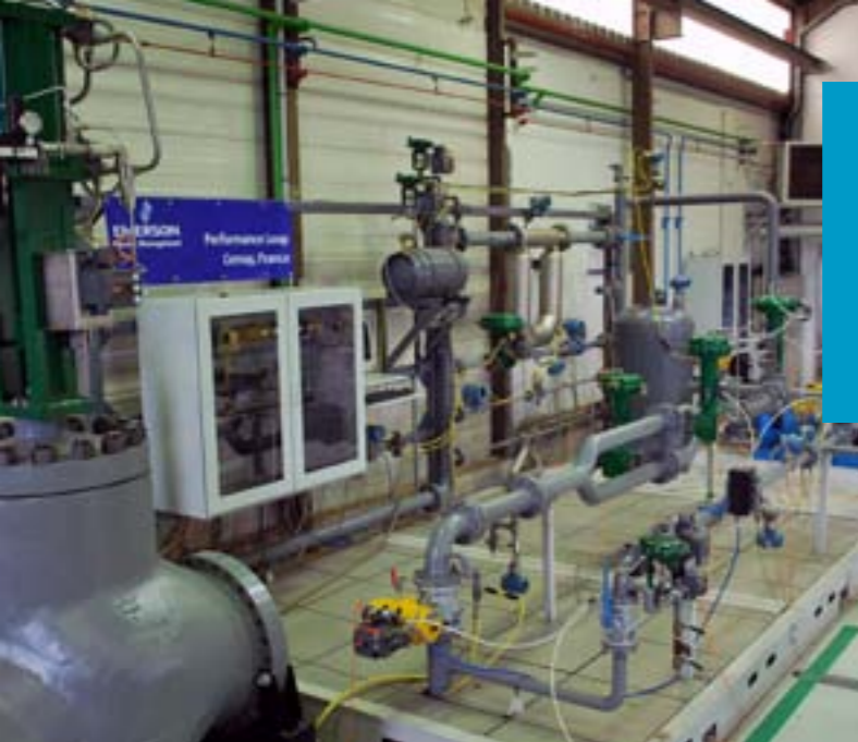
Leistungstestkreis, Durchflusslabor Cernay
