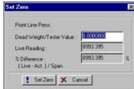
Figura 4-4. Exemplo de Calibração Ajuste Zero (Set Zero)
