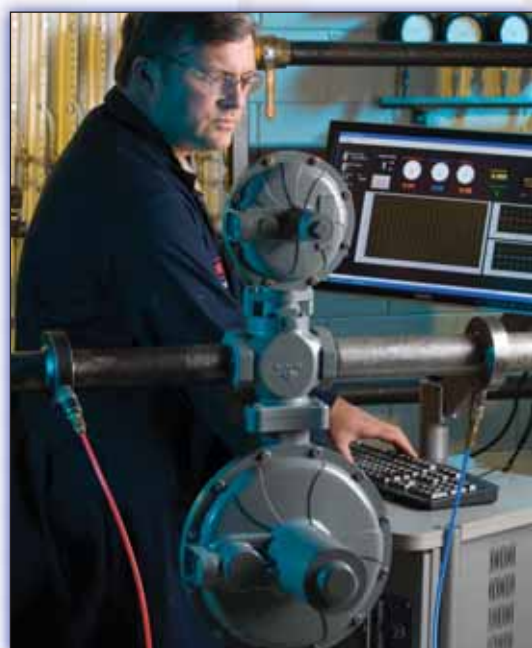
Test della Serie CS800 con la Protezione True-Monitor™ nel laboratorio Emerson a McKinney, Texas.
