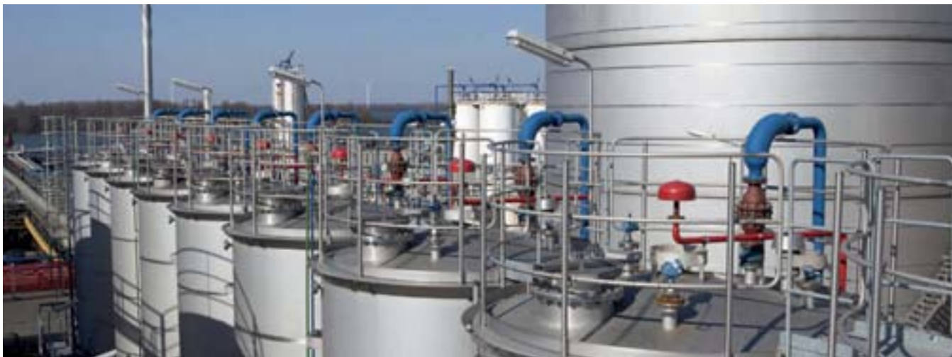
Alle tanks zijn voorzien van drukmeters, waarvan de meetwaarden direct naar het besturingssysteem worden gestuurd.
