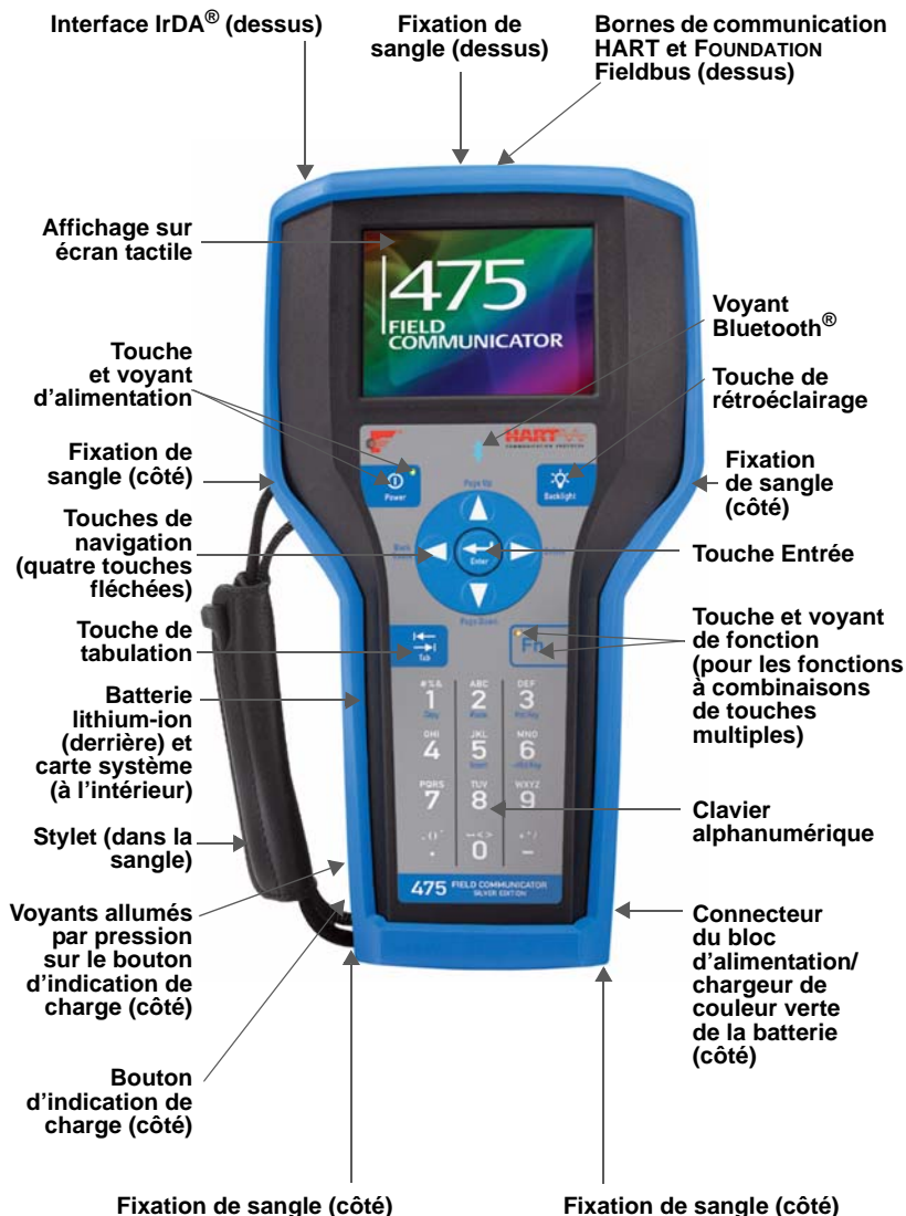
Figure 1. Interface de communication 475 avec soufflet de protection en caoutchouc
