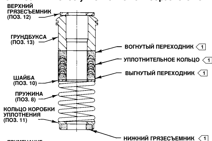
Рис. 2. Сальниковое уплотнение из V-образного кольца из ПТФЭ
