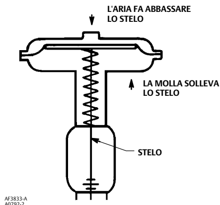
Figura 2. Schema degli attuatori 657 e 657-4 Fisher
