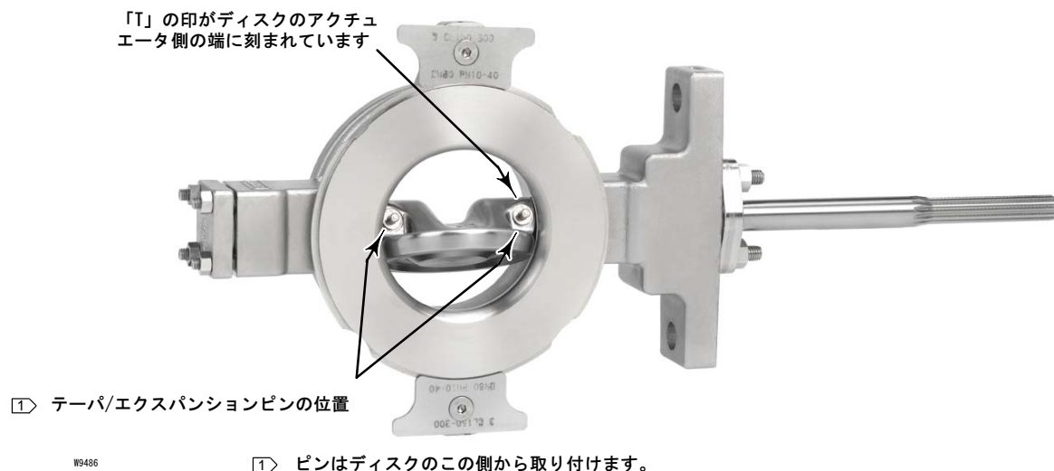
図 6. テーパ/エクспанションピンの取り付け
