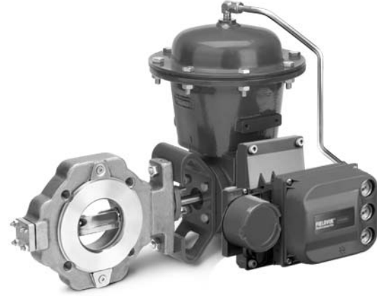
Şekil 1. 2052 Kumandalı ve DVC6200 Dijital Valf Kumanda Birimli Fisher Control-Disk Valf
