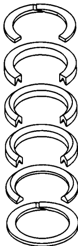
KOLEJNOŚĆ UŁOŻENIA PIERŚCIENI USZCZELNIAJĄCYCH Z PTFE
