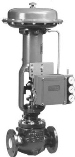
Figura 1. Montaje típico de los posicionadores Fisher 3582/3582i y los transmisores 3583
