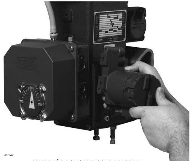
SEPARAÇÃO DO CONVERSOR DA PLACA DA BASE DO POSICIONADOR
