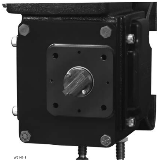
BARRA DO TIRANTE, PLACA DE MONTAGEM REMOVIDA
