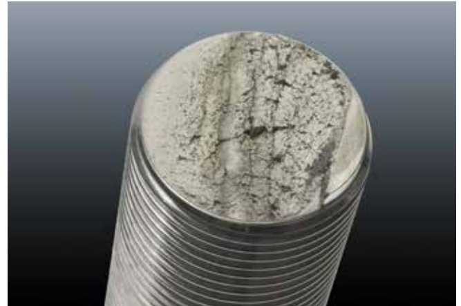
Une rupture de la tige de la vanne de régulation est une fracture de fatigue courante due aux fortes vibrations dans le système.
