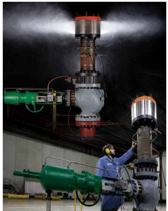
Test de bruit d'un diffuseur à événements NPS 12.
