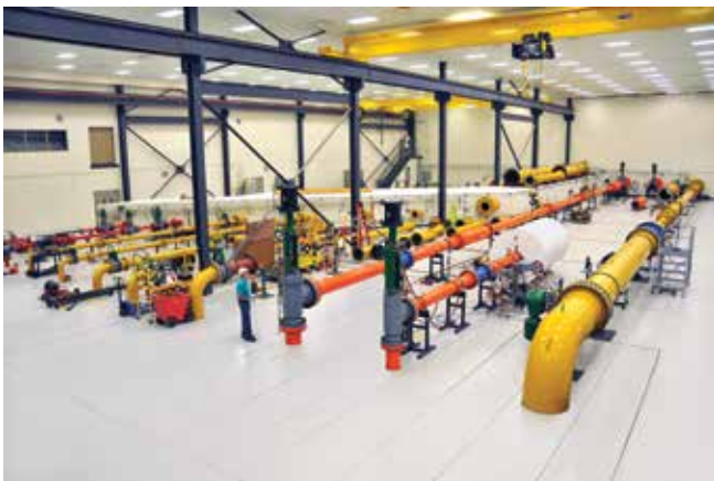
Les modèles de vannes de régulation de Fisher subissent des tests complets dans le laboratoire de 2 323 m 2 (25 000 ft 2 ) de l'Emerson Innovation Center, le centre de développement de vannes de régulation le plus grand et le plus complet du monde.
