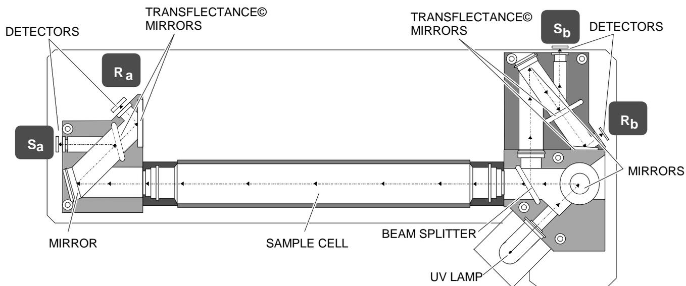
**FIGURE 1-1. MODEL 890 OPTICAL BENCH**
