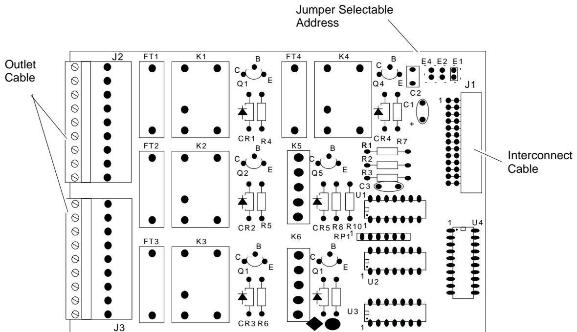
**FIGURE 2-4. AUTO ZERO/SPAN CONNECTIONS**
