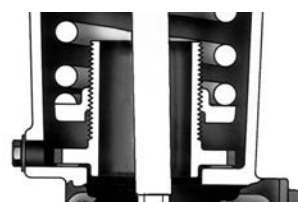
配备可调弹簧座的典型 1052 型执行机构
