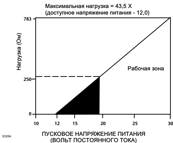
Рис. 10. Требования к источнику питания и сопротивлению нагрузки
