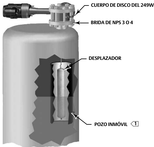
Figura 4. Sensor Fisher 249W montado en la parte superior del depósito
