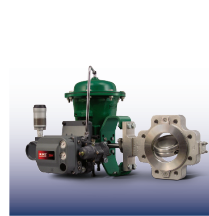
High Performance Butterfly Valves Typ : 8580 & Control-Disk™ 2" bis 12" und CL 150 bis 600 / PN 10 bis 40 WCC, 1.0619, CF3M SST, 1.4409 SST
