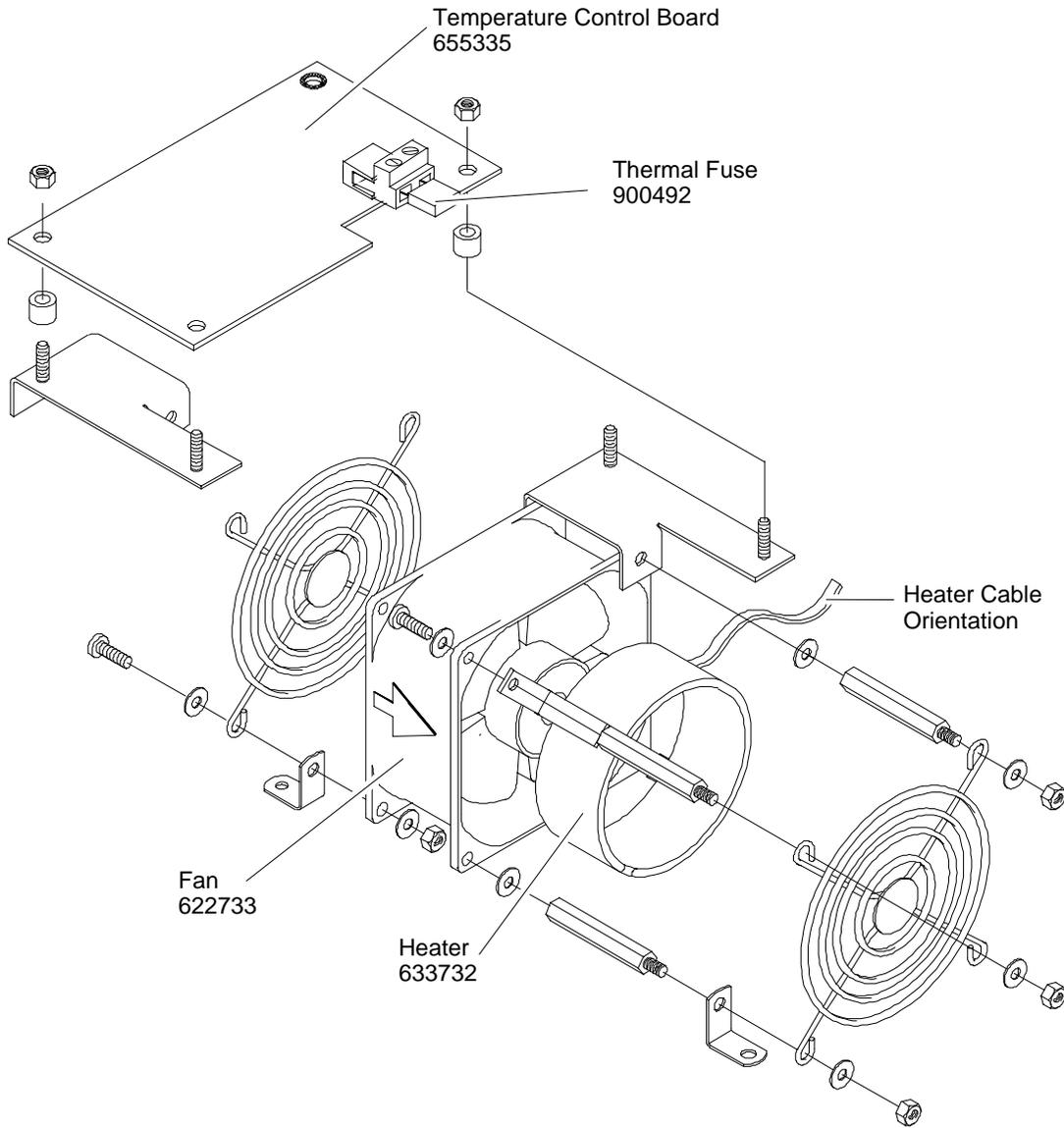
**FIGURE 6-4. CASE HEATER TEMPERATURE CONTROL ASSEMBLY**
