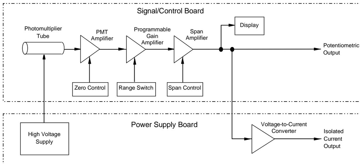
**FIGURE 4-1. ANALYZER SIGNAL CONDITIONING CIRCUIT**
