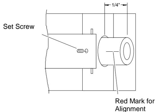
**FIGURE 7-6. LAMP ALIGNMENT**
