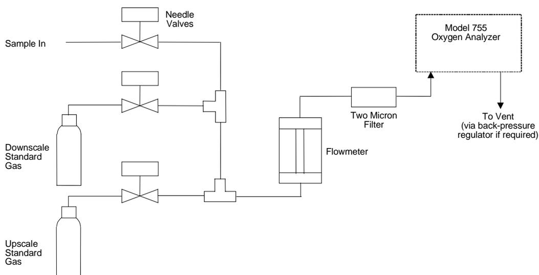
**FIGURE 2-8. CONNECTION OF TYPICAL GAS SELECTOR PANEL TO MODEL 755**
