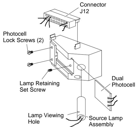
**FIGURE 7-3. DETECTOR/MAGNET ASSEMBLY**
