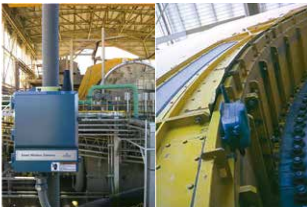
Контроль температуры в обмотках безредукторных двигателей
